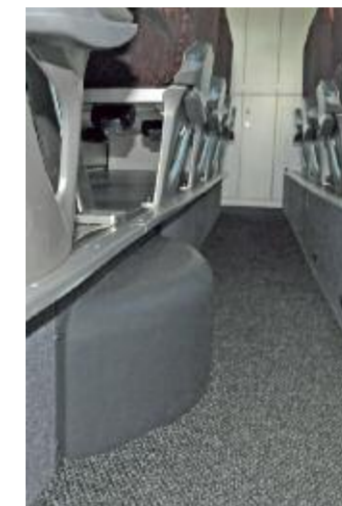
Stolperfalle: Hinter der halbrunden Abdeckung im Mittelgang des Unterdecks steckt das Reserverad.
