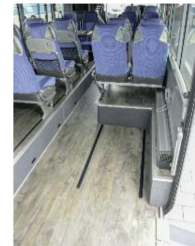
Stufenloser Einstieg bei Doppeldeckern. Der Rollstuhlfahrer den Zugang erleichtert. Hier ein Beispiel für den dafür gehaltenen Platz – Bordtelefon inklusive.
