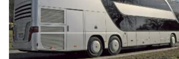
Unverkennbar TopClass: Die Form des Silberstreifens, der von der Tür schwingvoll zur Dachkante führt, spiegelt sich in der unteren Fensterreihe wieder. Dank seiner aktiv gelenkten Nachlaufachse lässt sich der Riese erstaunlich gut handeln.
