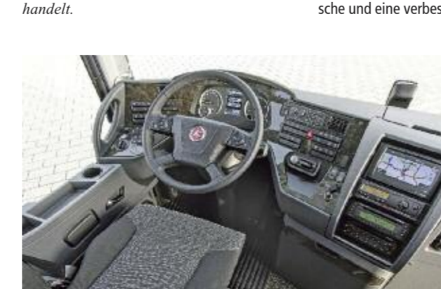
Schaltnaupf Adc: Das Automatikgetriebe wird wie der Retarder über den Lenkstockhebel bedient. Dies schafft mehr Raum. Neu sind zudem die Menüführung im Infodisplay und der Starterknopf.
