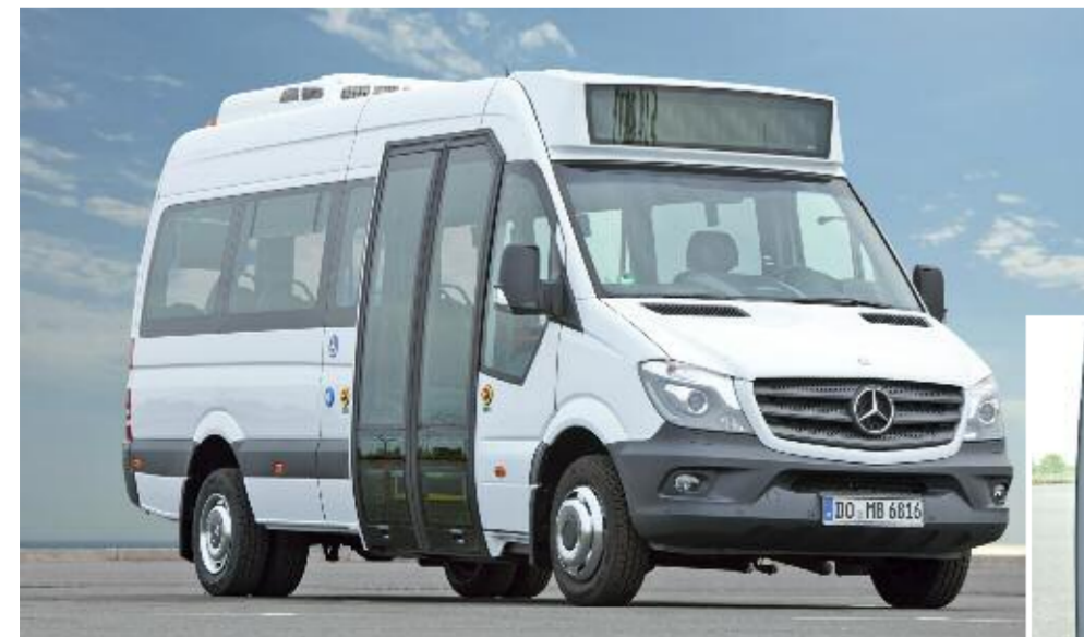
Sprinter City 35: Trotz großer Fahrtzielanzeige und elektrisch funktionierender Außenschwenktüren entspricht der Aufbau – bis auf die verglasten Flächen – weitgehend dem Kastenwagen.
