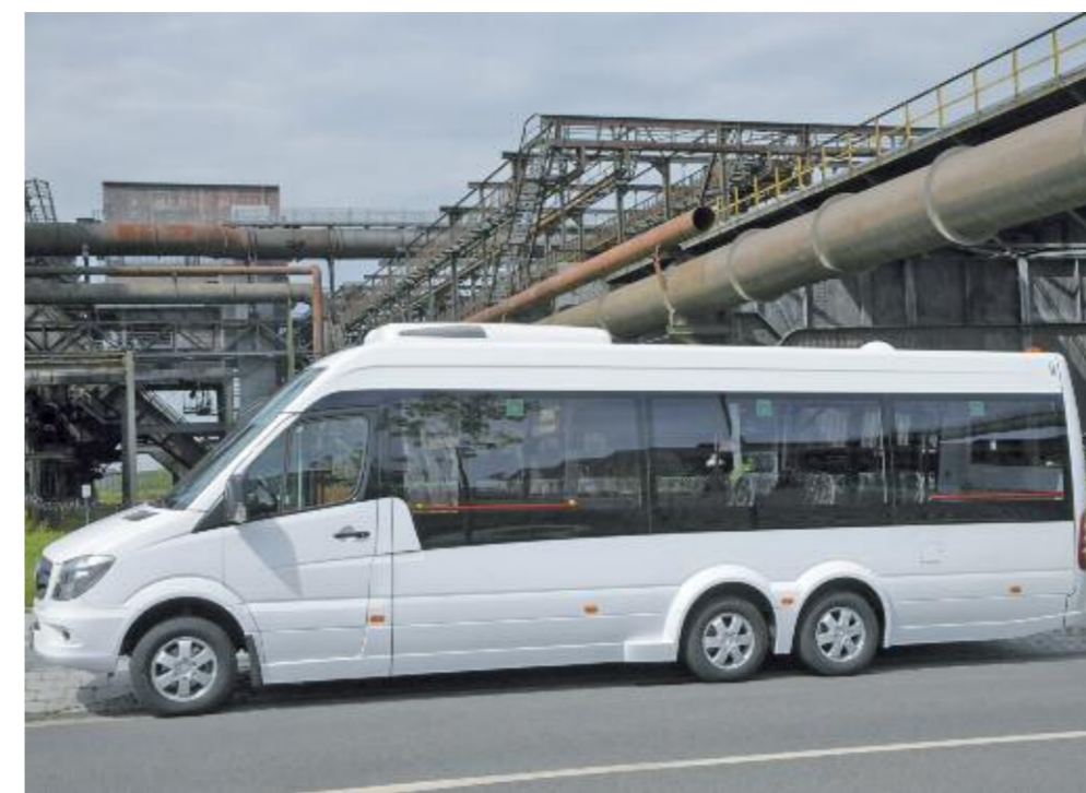
Der City 77, mit eigenständiger Basis und bustypischem Aufbau, wurde durchgehend niederflurig ausgelegt – mit einem leicht verwinkelten Mittelgang.
