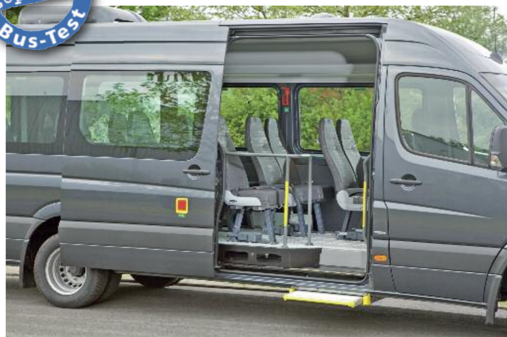
Der Sprinter Mobility ist weitgehend identisch mit den Kleinbussen der Transfer-Baureihe. So auch die elektrisch angetriebene Schiebetür.
