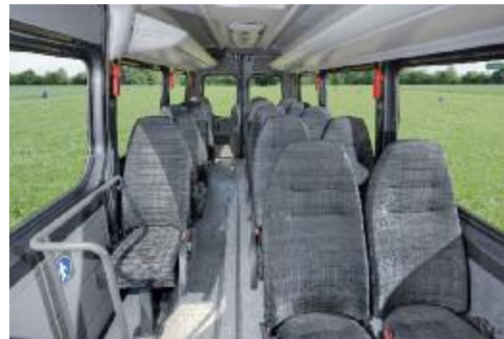
Die Befestigungsschienen im Mittelgang machen deutlich, dass es sich hier um den Sprinter Mobility handelt. Zur Beförderung von Rollstühlen können Stühle demontiert werden.
